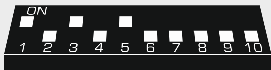
Rys. 14. Ustawienie przełączników DIP-switch w ekspanderze INT-O.
